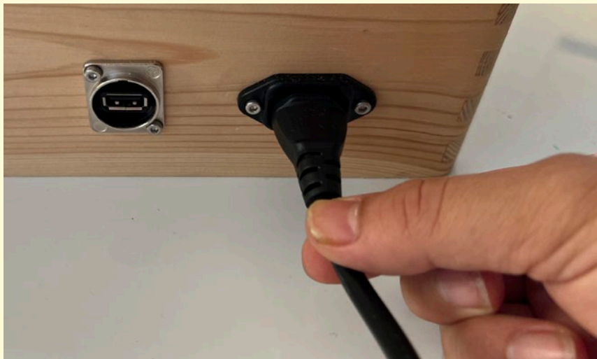
El apagado del Sonògraf se efectúa sacando el cable de alimentación. No hay botones de encendido/apagado.
